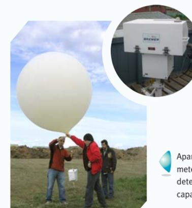
Aparato utilizado en una estación meteorológica que ayuda a la determinación del estado de la capa de ozono y su relación con el
